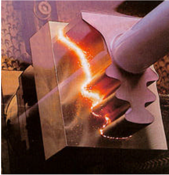
Fig. 2. Pieza de grandes dimensiones y forma compleja fabricadas por el proceso EDM.
