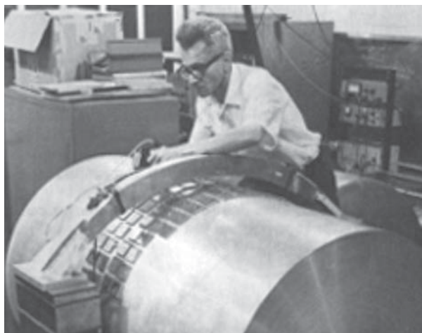
Fig.4. Joseph Weber fue el primer físico que se dedicó a diseñar y construir dispositivos para la detección de ondas gravitacionales. Weber propuso en los años 60's del siglo pasado el primer detector de masa resonante.
