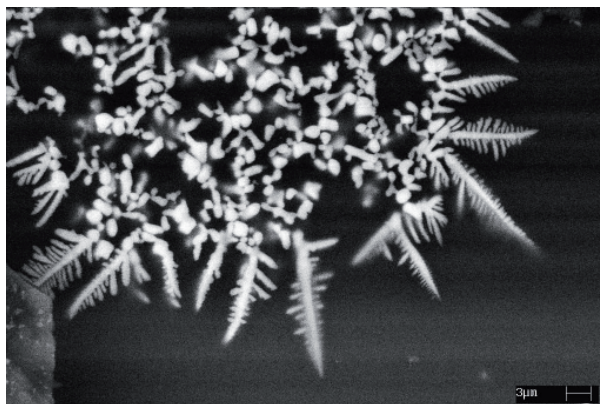
Fig. 9. Microestructura presentada por la zirconia a partir de su contacto con el vidrio.
