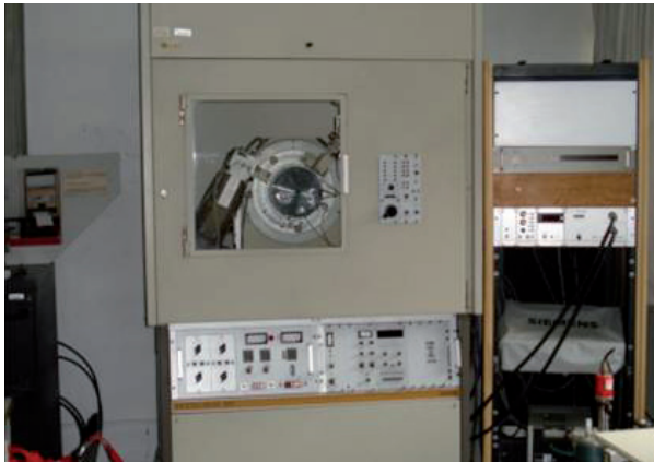
Equipo de difracción de rayos-x, Philips 5500 usado para evaluar las muestras.
