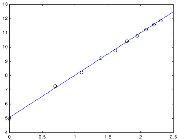
Fig. 3. Ajuste de datos transformados a una forma lineal  $\ln[y] = 2.96514 \ln[x] + 5.07782$ .
