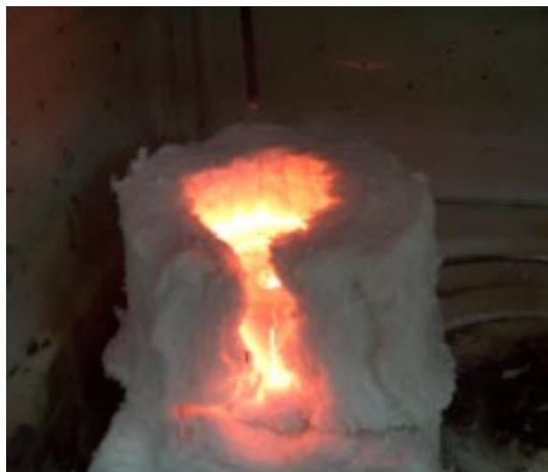
El conjunto que se observa en esta imagen consiste en un crisol rodeado de material aislante que se encuentra dentro de un horno de microondas. La parte más brillante, localizada al centro, corresponde a la parte del crisol que alcanzó más de  $1200^\circ C$ .
