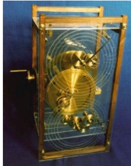
Fig. 8. Reconstrucción del Mecanismo de Anticitera. ("The Antikythera Mechanism"). Carta celeste para calcular la posición solar y lunar.
