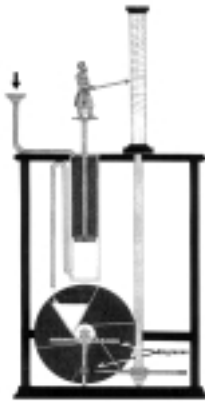
Fig. 7. Reloj de agua diseñado por Ctesbios de Alejandría en el que se utilizan engranes. 8
