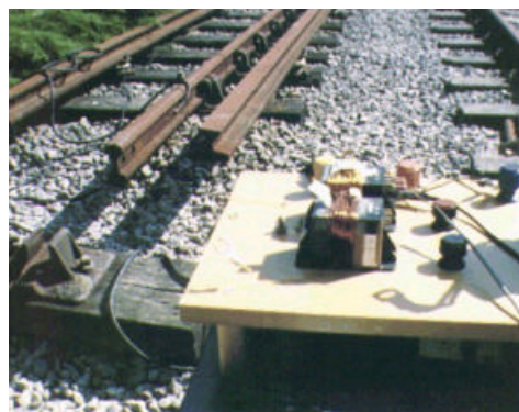
Fig. 4. Instrumentación para efectuar las medidas: sensor de efecto Hall.
