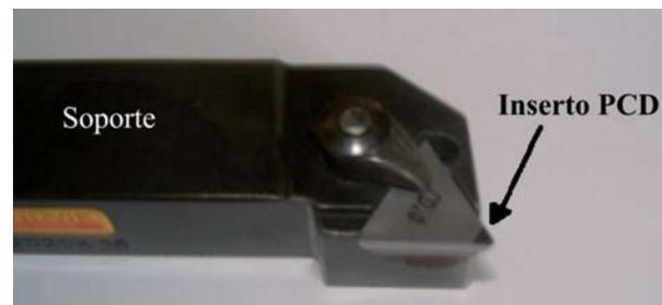
Herramienta utilizada en los ensayos de FRP
