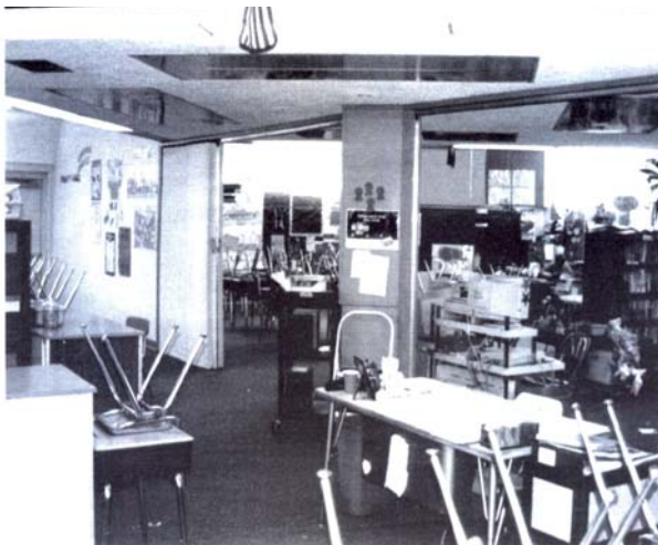
Fig. 9. Salones en plan abierto. Mientras pueden ser ventajosos para ciertos métodos de enseñanza o interacción estudiantil, tienen serias limitaciones acústicas. Aunque las divisiones parciales u operativas eliminan las distracciones visuales, prácticamente no proporcionan reducción de ruido entre los diferentes grupos.
