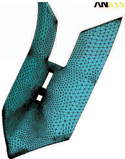
Fig. 2. Malla de elementos finitos de la herramienta de labranza.
