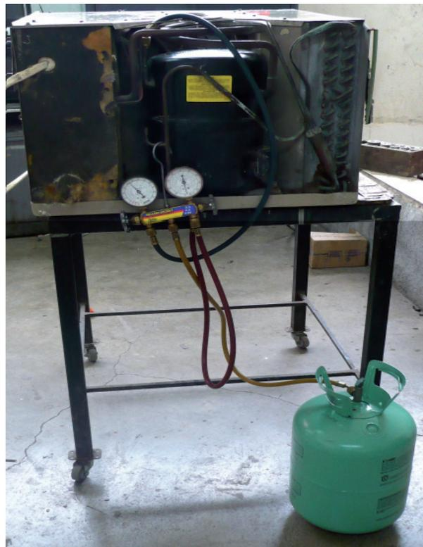
para la determinación del estado termodinámico en la zona de ebullición y condensación de las mezclas refrigerantes alternativas metanol - bromuro de litio y metanol - cloruro de litio, obteniendo un coeficiente de correlación de 99,99 % y un error promedio cercano al 1%, el error máximo obtenido por la red fue inferior al 3% .
