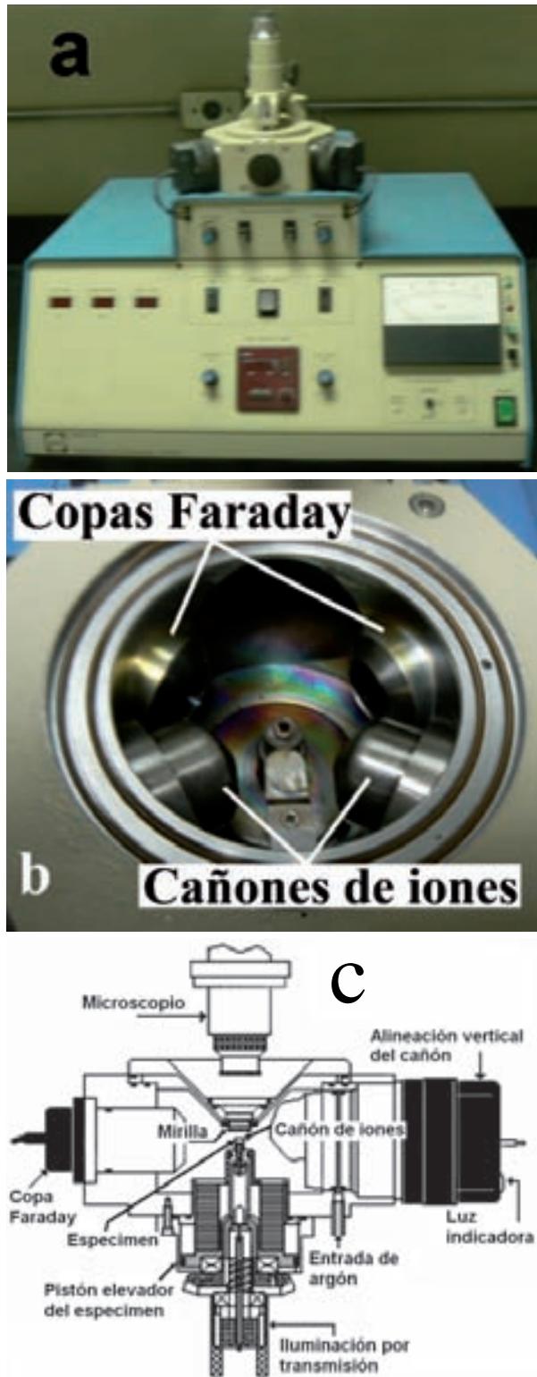
Fig. 1. Desbastador iónico. a) Vista frontal de equipo y b) arreglo del dispositivo en el interior de la cámara de trabajo. c).- Vista del dispositivo de bombardeo iónico al interior de la cámara.
