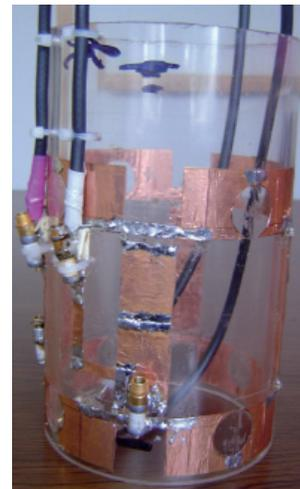
Fig. 1. Fotografía de una antena de cavidades resonantes para imagenología de la muñeca por IRM mostrando sus componentes electrónicos. Esta antena fue diseñada y optimizada para IRM de la mano.
