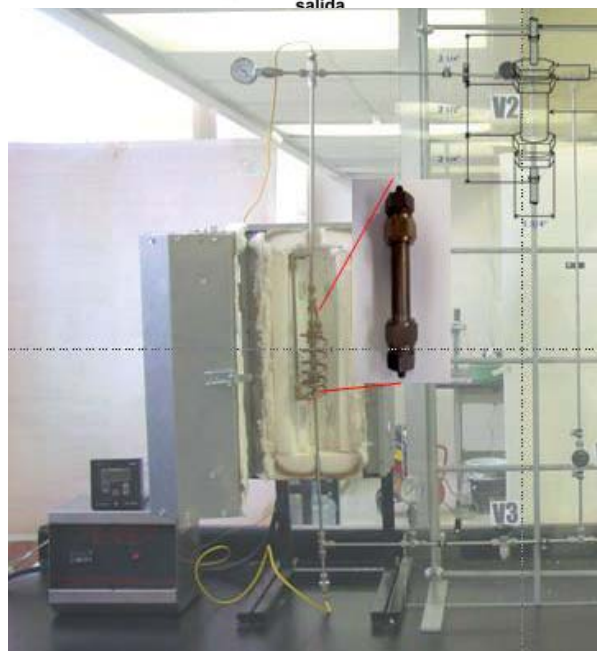
Fig. 1. Sistema de reactor experimental para las pruebas catalíticas.
