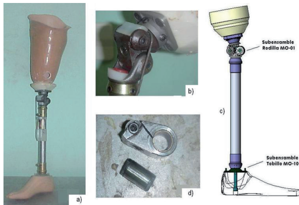
Fig. 1. a) Prótesis externa del tipo transfemoral (AK) utilizada en Cuba; b) rodilla MO-01 c) modelo 3D; d) Par buje-pasador.
