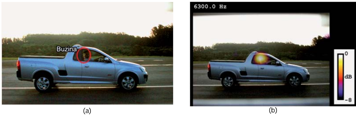
Fig. 7. a. Posición en que la bocina fue accionada; b. Procesamiento de la señal de referencia de 6.30 kHz, La escala dinámica coloreada (ver versión en Internet de la revista) en dB relativa.
