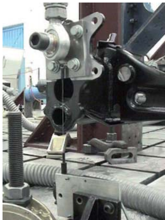
Fig. 3. Medición de desplazamiento, (a) Instrumentación y (b) gráfica de desplazamiento.
