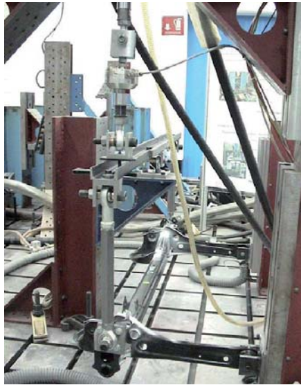
Fig. 2. Prueba de torsión de eje trasero. a) Cilindro, b) Celda de carga, c) Dispositivo para prueba de torsión d) Eje trasero (Pieza de prueba).
