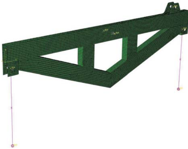
Fig. 11. Modelo de elemento finito encontrado mediante optimización de forma.
