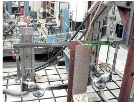
Fig. 4. Prueba de torsión de eje trasero.
