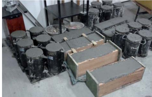
Fig. 5. Concreto vaciado en moldes de cilindros y vigas
