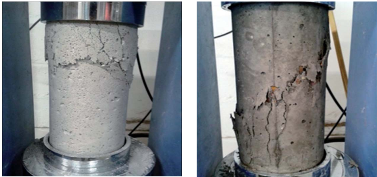
Fig. 7. Rotura a compresión de concreto sin adición de fibra de fique (izquierda) y con adición de fibra de fique (derecha).
