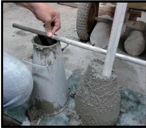
Fig. 4. Ensayo del slump o asentamiento.
