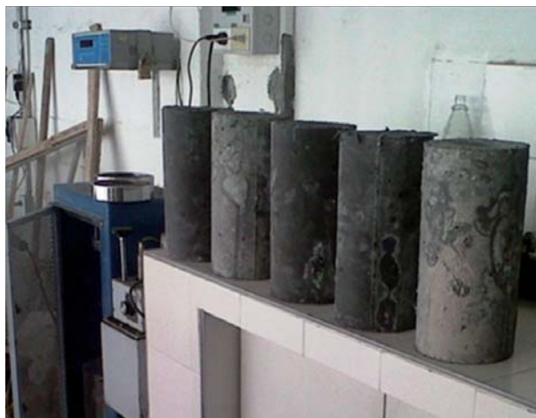
Fig. 6. Preparación de cilindros para ensayo a compresión.
