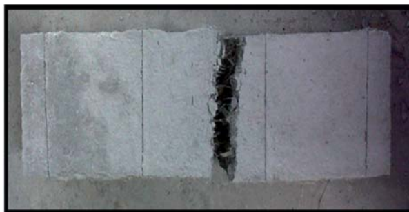
Fig. 8. Rotura a flexión de concreto con adición de fibra de fique.
