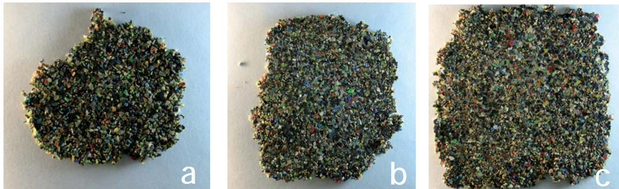
Fig. 2. Fotografías correspondientes a las placas de 100 % residuo, obtenidas mediante el método de compresión: a) compresión bajo las condiciones expuestas en métodos experimentales, b) compresión aumentando la temperatura y c) compresión incrementando la temperatura y la presión.
