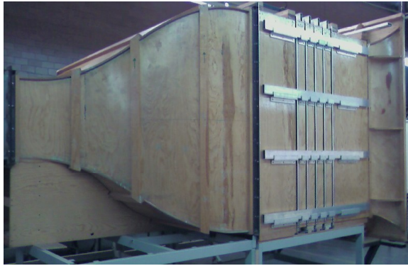
Fig. 9. Túnel de viento de LABINTHAP del IPN.
