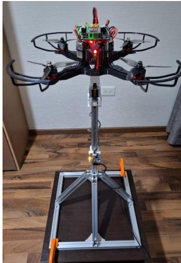
Fig. 6. Cuadrirrotor impreso en 3D bajo pruebas experimentales de fuerza y torque.
