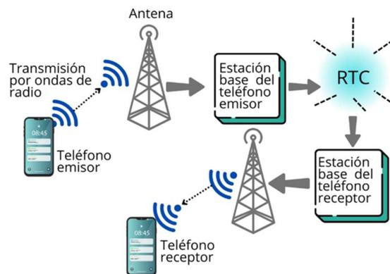
Fig. 11. Funcionamiento de una llamada por teléfono celular.
