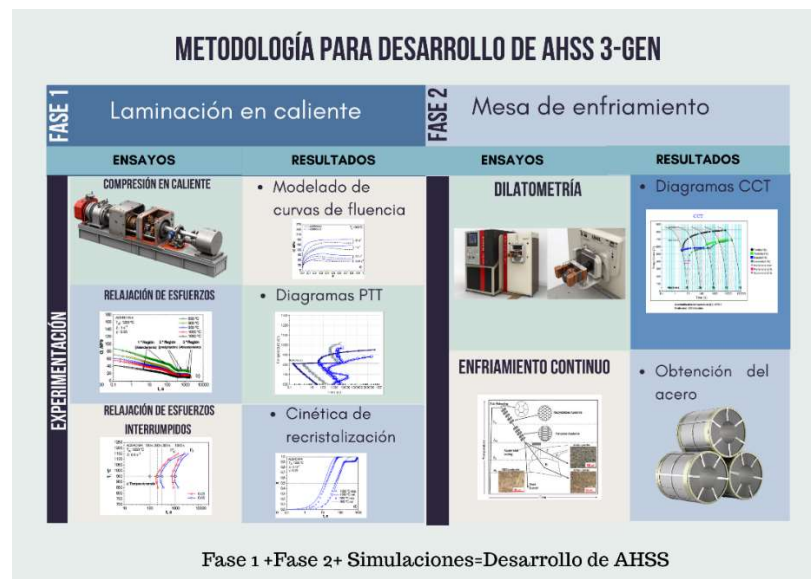
Fig. 5. Diagrama para el desarrollo de aceros avanzados de alta resistencia (AHSS).
