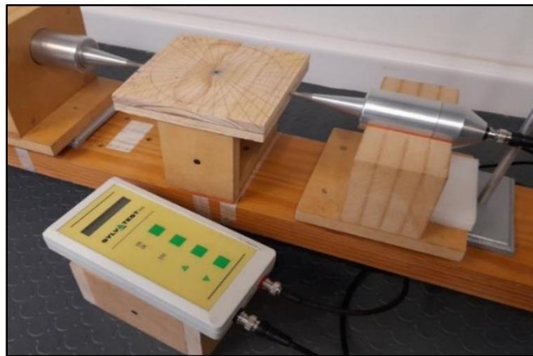
Fig. 3. Montaje experimental para las pruebas de ultrasonido no destructivas con el instrumento Sylvatest.
