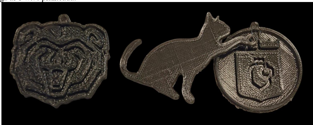
Fig. 7. Impresiones 3D obtenidas a partir de filamento PLA-BCS.
