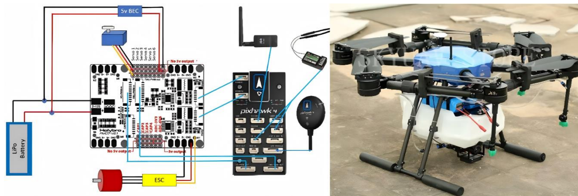
Fig. 5. Plataforma experimental considerada como referencia para la implementación del esquema propuesto. (Izquierda) Arquitectura electrónica de un sistema de control automático basado en Pixhawk 4, que integra el controlador de vuelo, módulos de comunicación, sistema de posicionamiento y elementos de potencia utilizados para el control y la navegación del vehículo aéreo. (Derecha) Hexacóptero utilizado como plataforma aérea el cual puede ser utilizado en aplicaciones reales de siembra aérea autónoma en agricultura de precisión.
