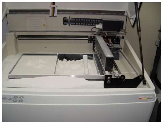
Fig. 3. Impresión 3D ZCorp del patrón de calibración.
