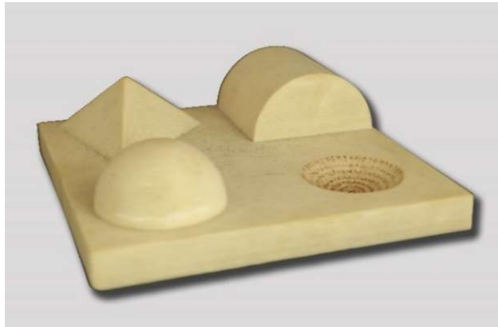
Fig. 3. Impresión 3D ZCorp del patrón de calibración.
